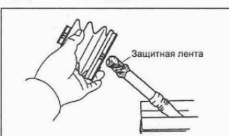
6. Установите тройной шарнир на приводной вал.
